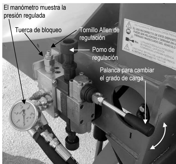
Regulación de la válvula manual de detección de carga.
