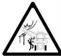
Peligro: Posible colisión con líneas eléctricas
