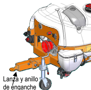
Equipos arrastrados: mover utilizando el enganche
