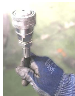
Conector normalizado ISO 5676 para el freno de servicio hidráulico tipo “conducto único” (no disponible en EU)
