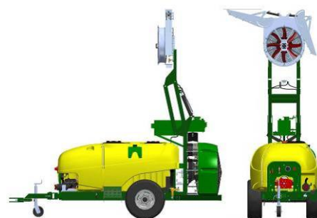
Doble ventilador, con función de elevación: sin Joystick, el elevador se alimenta de una toma presión – retorno.
