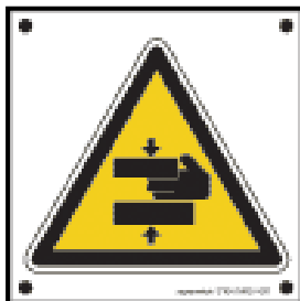
Riesgo de aplastamiento
