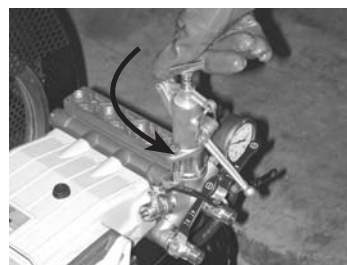
6) Girar a izquierdas el regulador (presión 0)
