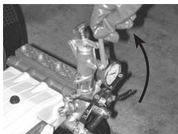
7) Llevar la palanca del regulador a DESCARGA
