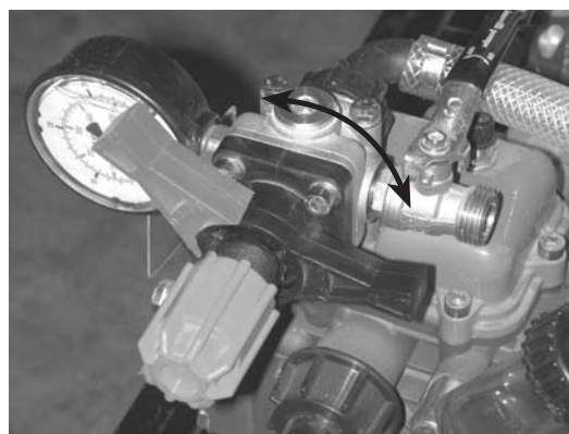
Palanca modos DESCARGA - PRESIÓN en el regulador C-6 ó C-11.
