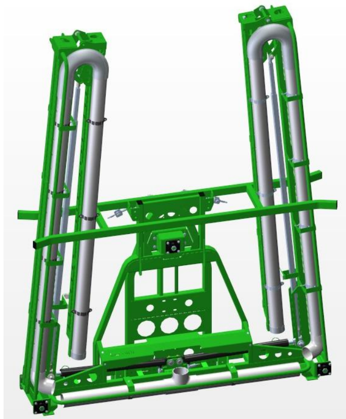
Fig. 3: Vista general de barra hidráulica.
